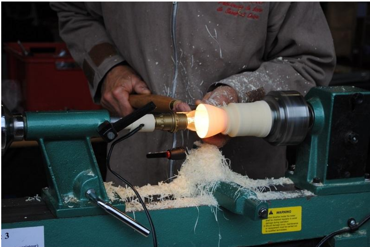
Calibrage de l'épaisseur à la lampe .
